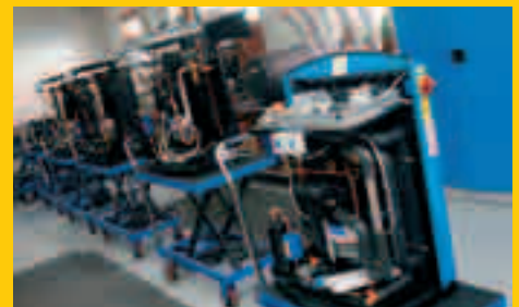
PROIZVODNJA OGREVALNIH TOPLOTNIH ČRPALK
